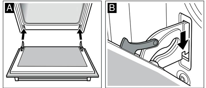
Wenn die Scharniere nicht korrekt eingebaut werden, kann die Tür verschoben sein.
