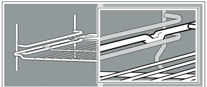
Je nach Ausstattung verfügt das Gerät über Auszugsschienen, die leicht einrasten, wenn sie ganz herausgezogen werden. So lässt sich das Zubehör leicht hineinstellen. Zum Entsperrn die Auszugsschienen mit etwas Druck wieder in den Backofen schieben.
