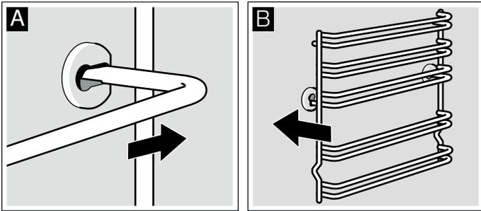
Die Gestelle oder Schienen werden rechts und links eingehängt. Die Ausbuchtung muss immer nach unten zeigen.
