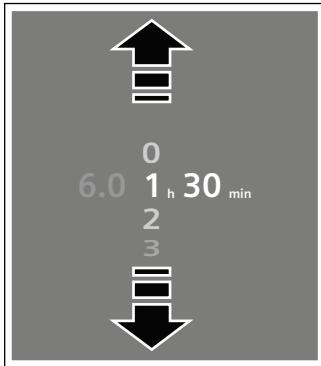
Die eingestellte Dauer wurde übernommen. Die Dauer läuft sichtbar in der Anzeige ab.
