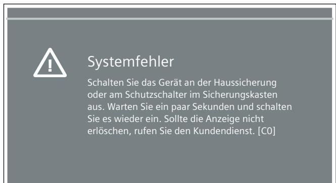
**Hinweis:** Bei einigen Fehlermeldungen wird ein Fehler-Code angezeigt (Beispiel: [C0])
