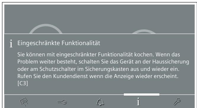
**Hinweis:** Bei einigen Warnungen wird ein Fehler-Code angezeigt (Beispiel: [C3])
