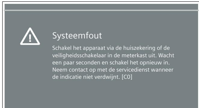
**Aanwijzing:** Bij enkele foutmeldingen wordt een foutcode weergegeven (Voorbeeld: [C0])
