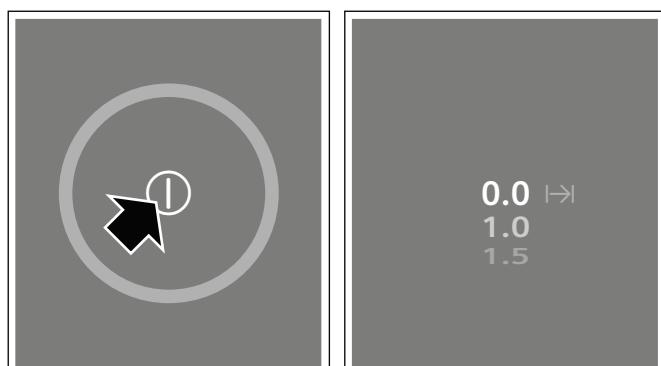
3. Dans les 4 secondes, faire défiler vers le haut et régler le niveau de chauffe désiré.
