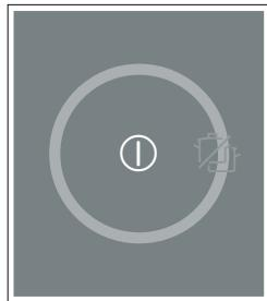
Se compare questo simbolo sull'indicatore delle zone di cottura significa che le impostazioni non sono state trasmesse in modo completo. Sollevare la stoviglia o spostarla sulla superficie di cottura. Impostare nuovamente la zona di cottura.
