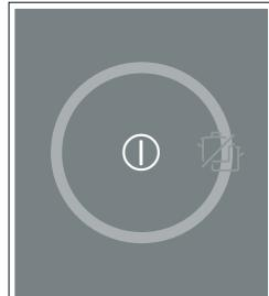
Si ce symbole apparaît dans l'affichage de la position de cuisson, les réglages n'ont pas pu être transférés complètement. Soulevez le récipient ou déplacez-le sur la surface de cuisson. Réglez de nouveau la position de cuisson.
