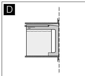
Der Tank muss bündig mit dem Tankschacht sein (Bild D).
