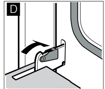
Die Gerätetür ist gesichert und kann nicht mehr ausgehängt werden.
