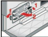
5. Luftkühler entfernen.
