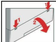
3. Beide Verschlusshebel nach außen drehen (1).
