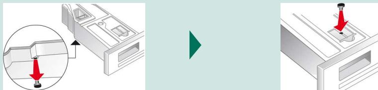
Rode a parte inferior do reservatório da água de condensação 180° e retire o tampão que aí se encontra inserido.
