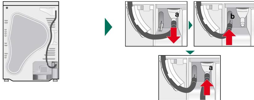
Estado de fornecimento da máquina de secar: A mangueira está fixa ao bocal para que a água de condensação seja escoada para o respectivo reservatório.
