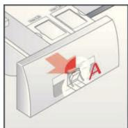
2. Tirez légèrement à vous le levier de décrantage (A) situé au dos de la poignée du bac (en bas au milieu) et simultanément ...
