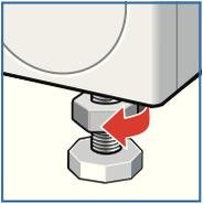
1. Desserrez le contre-écrou dans le sens des aiguilles d'une montre à l'aide d'une clé à vis.
