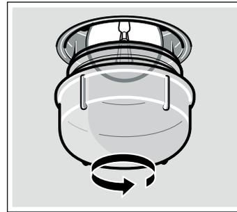
3. Lampe durch den gleichen Lampentyp ersetzen.
