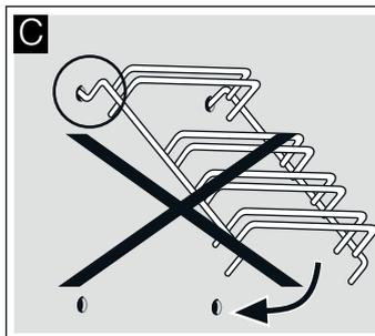
2. Die zwei Haken müssen vollständig in den oberen Löchern eingehängt sein. Jetzt das Gestell langsam und vorsichtig nach unten bewegen und in die unteren Löcher einhängen (Abbildung D).
