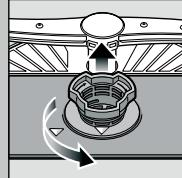
Rodar o filtro cilíndrico
