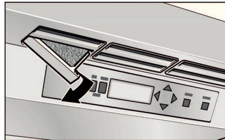
2. Verbrauchten Geruchsfilter herausnehmen und neuen Geruchsfilter einsetzen.
