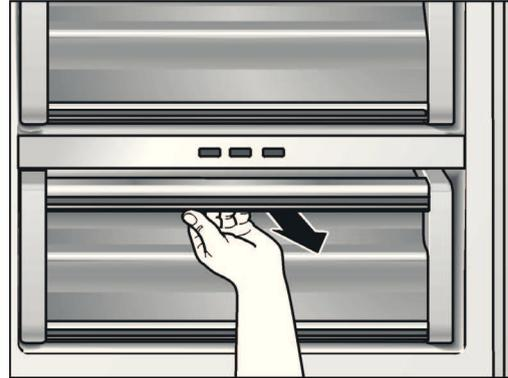
Die Filterabdeckung abheben, Filter herausnehmen.
