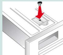
Vrid behållaren 180° tillbaka och tryck in proppen i öppningen på kondensvattenbehållarens ovansida.
