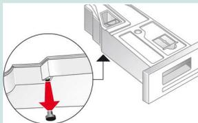
Vrid kondensvattenbehållaren 180° på undersidan och lossa den plugg som sitter där.
