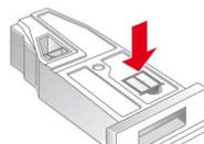
Lägg in filtret i fördjupningen på kondensvattenbehållaren.
