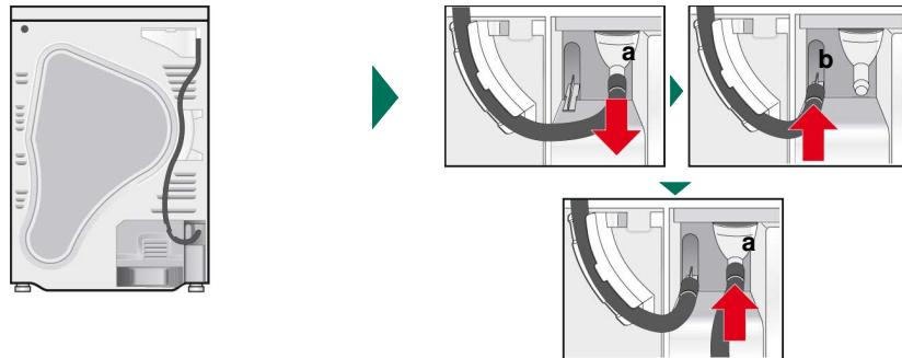
Leveringstilstanden til tørketrommelen: For å lede kondensvannet til kondensvannbeholderen er slangen festet på stussen.
