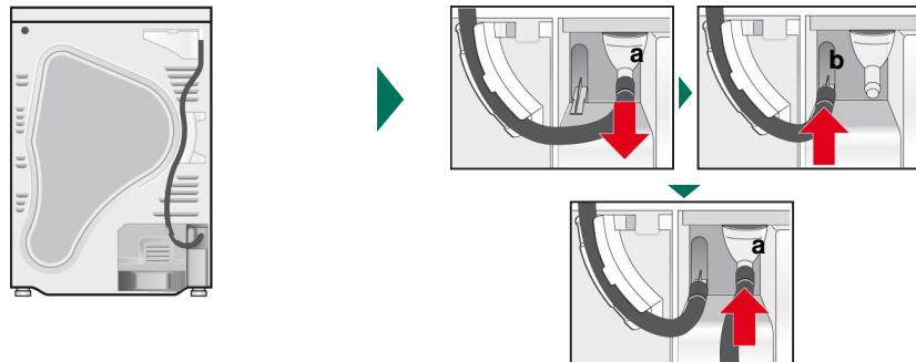
Rumpukuivaajan toimitustila: Kondensiveden poistoon tarkoitettu letku on kiinnitetty kondensivesisäiliöön liitokseen.
