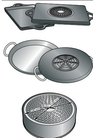
Lorsqu'on utilise de grands récipients de moindre surface ferromagnétique, seule la zone ferromagnétique se réchauffe, et la distribution de chaleur peut donc ne pas être homogène.
