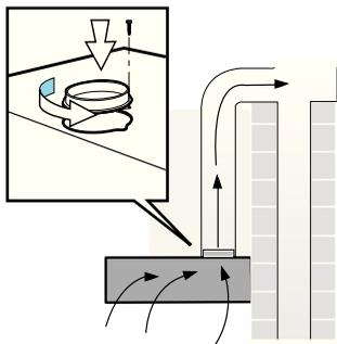
O ar viciado é evacuado para cima por meio de um tubo de descarga ou directamente para fora atravessando a parede.
