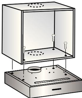
1. De afmetingen van de gaten voor de montage zijn te vinden aan de onderkant van het hangkastje of door de boormal op de bodem te plaatsen.
