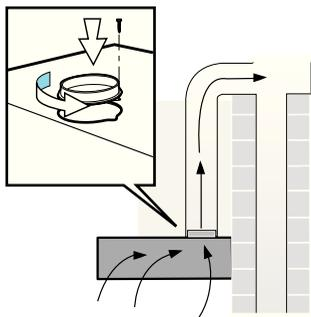
I fumi della cucina vengono espulsi attraverso un condotto di scarico verso l'alto o direttamente verso l'esterno attraverso la parete.
