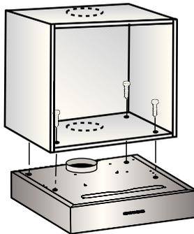
1. Los tamaños de los agujeros para el montaje, se pueden conseguir en la base del armario o colocando un calibre de perforación encima de la base.
