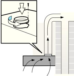
De afgezogen lucht wordt aan de bovenkant naar buiten toe afgevoerd door een ventilatieschacht of direct door de buitenwand.
