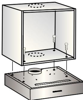
1. Monteringshålens dimensioner kan finnas angivna på det upphängda köksskåpets undersida eller erhålls genom att man placerar bormallen på skåpets undersida.
