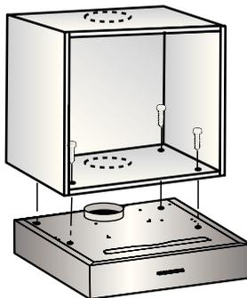
1. Hullernes dimension til montering kan man finde på basis af den ophængte hylde eller ved at anbringe en hulskabelon på basen.
