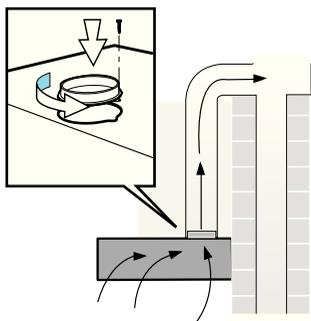
L'air vicié est évacué vers le haut par un conduit d'aération ou directement à l'air libre par traversée du mur extérieur.
