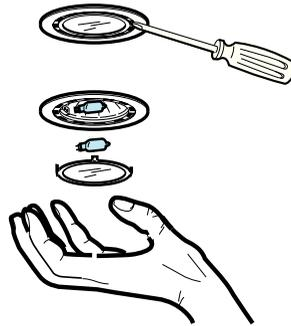
3. Vervang het lampje (gebruik alleen halogeenlampjes van max. 20 Watt - G4).
