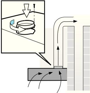
Poistoilma ohjataan ylös tuuletuskanavaa pitkin tai suoraan ulkoilmaan ulkoseinän lävitse.
