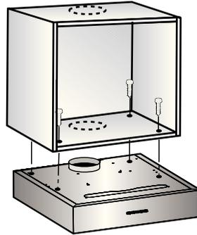
1. Asennusreikien mitat löytyvät ripustetun kaapin pohjalta tai asettamalla porausmallin kaapin pohjalle.
