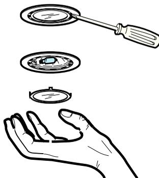
3. Sostituire la lampada danneggiata solo con lampade da **20 W max. (G4)**.
