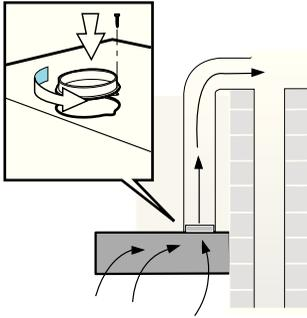
El aire viciado se evacua hacia arriba a través de un tubo de descarga o directamente hacia el exterior atravesando la mampostería.
