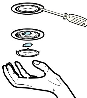
3. Trocar a lâmpada danificada (lâmpadas alógenas máx. 20 Watt, G4).
