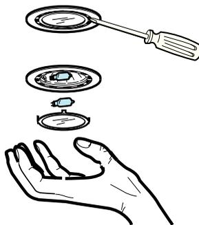
3. Remplacez l'ampoule défectueuse (lampes halogènes max. 20 Watt, G4).
