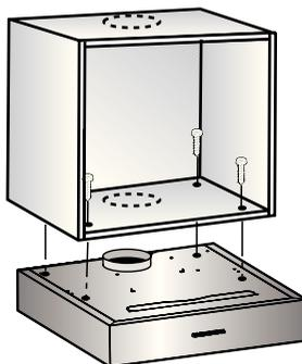
1. Le dimensioni dei fori per il montaggio possono essere trovate nella base del pensile appeso o posizionando una dima di foratura sulla base.
