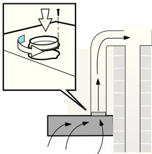
Den insugna luften släpps ut genom en ventilationskanal eller direkt utomhus genom en yttervägg.
