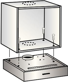
1. Maße für die Befestigungslöcher aus den Bildern entnehmen oder Schablone an den Boden des Oberschranks anlegen.
