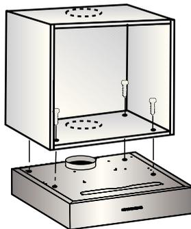
1. As dimensões dos furos para a montagem podem-se encontrar na base da prateleira pendurada ou posicionando um molde de perfuração sobre a base.
