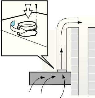
Die Abluft wird über einen Lüftungsschacht nach oben, oder direkt durch die Außenwand ins Freie geleitet.
