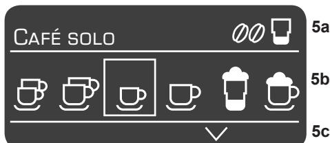
En la barra de estado **5a** del display **5** se visualiza el nombre del tipo de bebida y el ajuste de la intensidad p.ej. **00** y de la cantidad p.ej. **█**. En la barra de selección **5b** se representan símbolos para la selección de bebidas.
