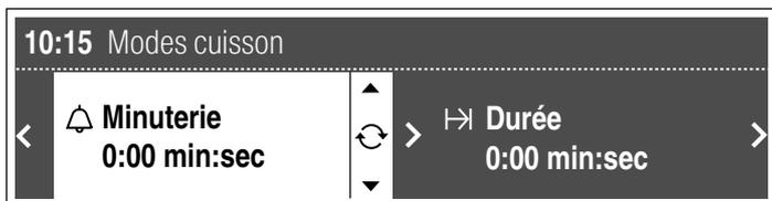
2. Commuter à la durée au moyen de la touche > ou < et régler la durée au moyen du sélecteur rotatif.
