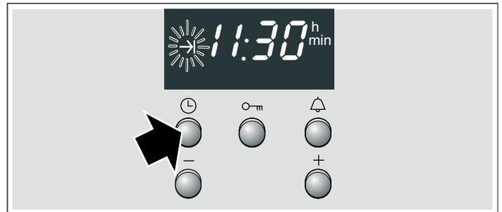
6. Mit der Taste + die Endezeit auf später verschieben. Nach einigen Sekunden wird die Einstellung übernommen. In der Anzeige steht die Endezeit, bis der Backofen startet.
