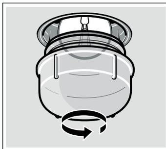
3. Lampe durch den gleichen Lampentyp ersetzen.
