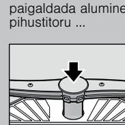
paigaldada alumine pihustitoru ...
