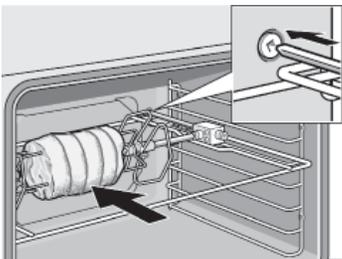
7. Placez la grille dans le four et insérez l'arbre moteur dans l'ouverture du mur du fond.
