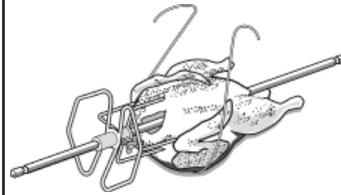
1. Glissez l'une des fourches sur la broche en pointant les dents vers l'extrémité. Serrez la vis pour l'empêcher de glisser.
