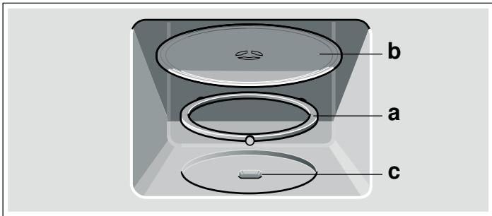
**Nota:** Utilize o aparelho apenas com o prato rotativo colocado. Certifique-se de que está correctamente encaixado. O prato rotativo pode rodar para a esquerda ou para a direita.
