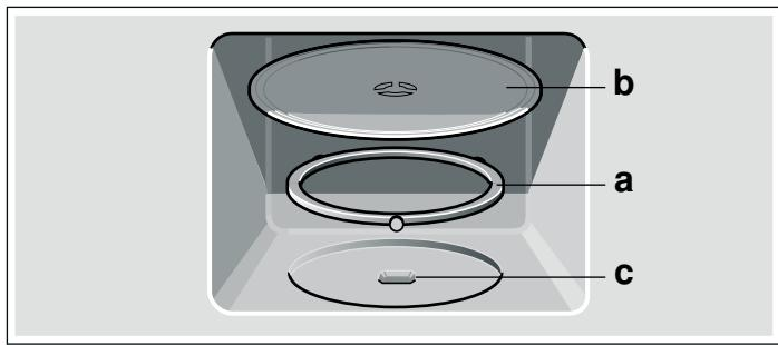
**Nota:** Utilizar el aparato solo cuando el plato giratorio esté colocado. Asegurarse de que queda correctamente enclavado. El plato giratorio puede girar hacia la izquierda o hacia la derecha.
