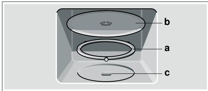
**Bemærk:** Anvend kun apparatet med indsæt drejetallerken. Kontroller, at den er gået korrekt i indgreb. Drejetallerkenen kan drejes både mod venstre og mod højre.
