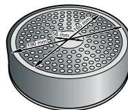
Para obter bons resultados de cozedura, recomenda-se que o diâmetro da área ferromagnética do recipiente seja adaptado ao tamanho da zona de cozedura. Se o recipiente não for detectado numa zona de cozedura, experimente-o na zona de diâmetro imediatamente inferior.
