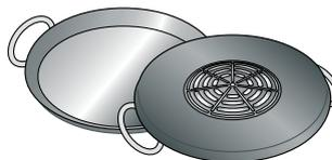
Os recipientes com zonas de alumínio inseridas na base reduzem a área ferromagnética, pelo que o calor fornecido pode ser menor ou podem surgir problemas de detecção.
