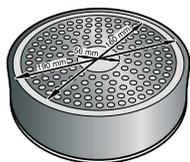
Para obtener buenos resultados de cocción, es recomendable que el diámetro del área ferromagnética del recipiente se ajuste al tamaño de la zona de cocción. Si el recipiente no es detectado en una zona de cocción, pruébelo en la zona de diámetro inmediatamente inferior.
