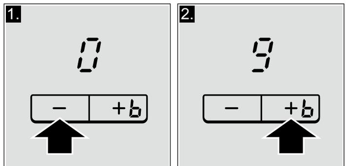
3. Modifier le niveau de puissance : appuyer sur le symbole + ou - jusqu'à ce que le niveau de puissance souhaité apparaisse.
