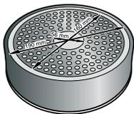
Afin d'obtenir de bons résultats de cuisson, le diamètre de la surface ferromagnétique devrait être adapté à la taille de zone de cuisson. Si le récipient n'est pas détecté sur une zone de cuisson, l'essayer sur la zone de diamètre immédiatement inférieur.
