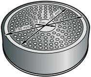
Om goede kookresultaten te verkrijgen, is het raadzaam dat de diameter van de ferromagnetische zone van de pan aangepast is aan de maat van de kookzone. Als de pan in de kookzone niet wordt gedetecteerd, controleer dan in de zone met een wat kleinere diameter.
