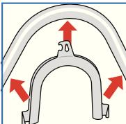
2. Svitare i raccordi di carico/scarico dai supporti e rimuovere gli elementi curvi di sostegno.
