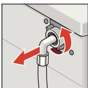
Svitare il raccordo di carico dell'acqua dal lato posteriore dell'apparecchio.
