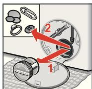
5. Svitare con precauzione il coperchio della pompa. Pulire interno, la filettatura del filtro pompa e corpo pompa (la girante della pompa deve ruotare liberamente).
