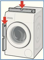
2. Ausrichtung der Waschmaschine mit Wasserwaage überprüfen, evtl. korrigieren. Höhe durch Drehen des Gerätefußes verändern.
