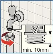
**am Wasserhahn ( $\frac{3}{4}'' = 26,4 \text{ mm}$ ):**
