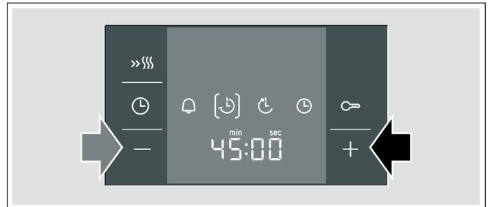
Nach wenigen Sekunden startet der Backofen. In der Anzeige läuft die Dauer sichtbar ab und das Symbol [⏏] leuchtet. Die anderen Zeitsymbole erlöschen.
