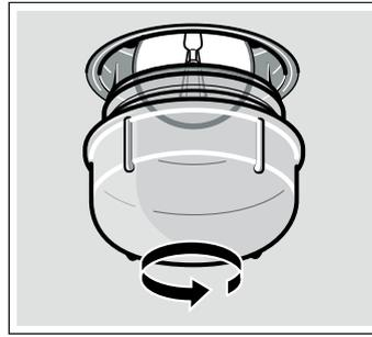
3. Lampe durch den gleichen Lampentyp ersetzen.
