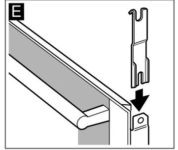
7. Poser le recouvrement et le visser. Si le recouvrement ne peut pas être vissé, vérifier si les vitres reposent correctement dans la fixation.
