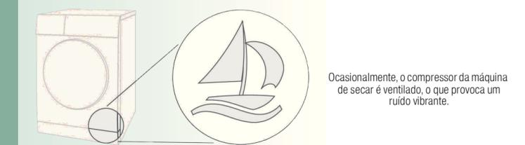
Ocasionalmente, o compressor da máquina de secar é ventilado, o que provoca um ruído vibrante.
