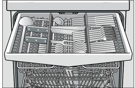
Je nach Modell können die seitlichen Ablagen heruntergeklappt werden, um mehr Platz für höhere Besteckteile zu erhalten. Die vorderen Stachelreihen können umgeklappt werden, um breitere Griffe einzusortieren.
