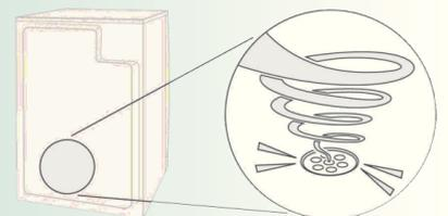
Das Kondenswasser wird mit einer Pumpe in den Kondenswasser-Behälter gepumpt, dabei entstehen Pumpgeräusche.
