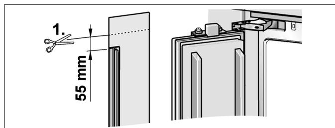
2. Du côté charnière, insérez le morceau découpé dans l'interstice entre l'appareil et la paroi de cavité.
