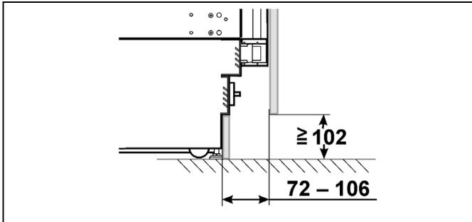
1. Le cas échéant, il sera nécessaire de découper le bandeau de socle à la longueur nécessaire.
