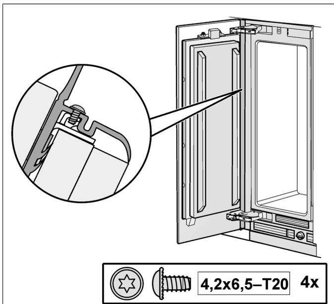
5. Ouvrez et fermez plusieurs fois la porte pour vérifier le fonctionnement du bandeau protège-doigts et qu'il n'oppose pas de résistance mécanique.
