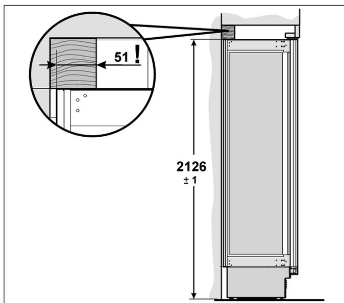
2. Sur la paroi arrière de la cavité, marquez la hauteur d'installation (bord inférieur du madrier).
