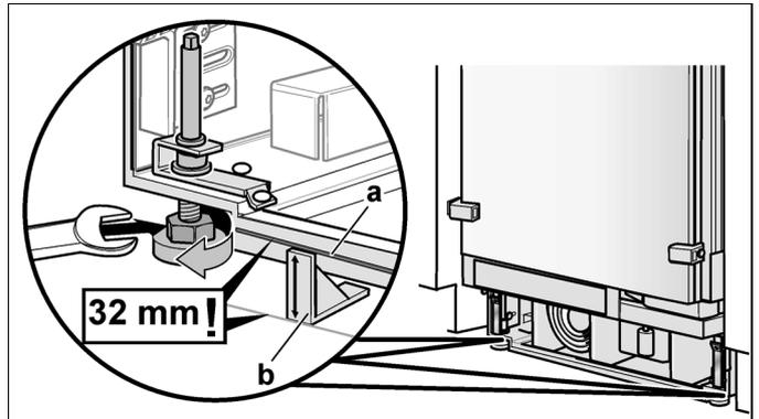
3. Corrigez la verticalité à l'aide des pieds à l'arrière de l'appareil. Utilisez un niveau à bulle !
