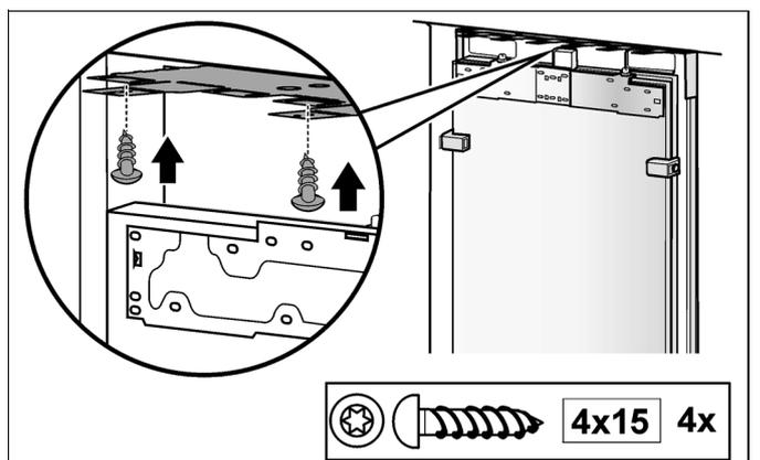
3. S'il y a suffisamment de place au dessus de l'appareil, fixez les nervures latérales des plaques de fixation (en haut) suivant la situation d'encastrement en présence.
