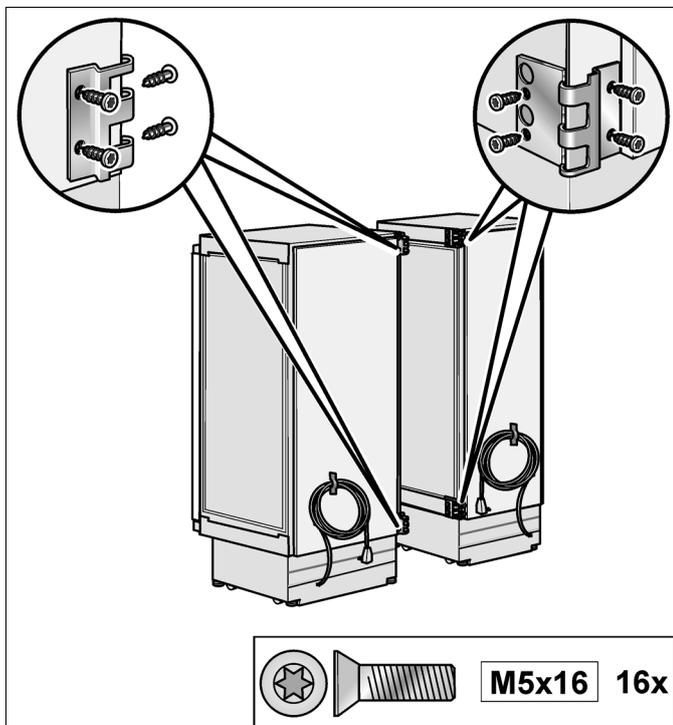
8. Poussez les appareils l'un vers l'autre jusqu'à ce que les cornières de liaison s'emboîtent l'une dans l'autre.
