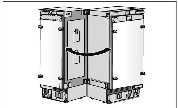
11. Dévissez les vis situées sur le dessus des appareils et vissez à la place les accessoires de montage puisés dans les accessoires d'installation côte-à-côte.
