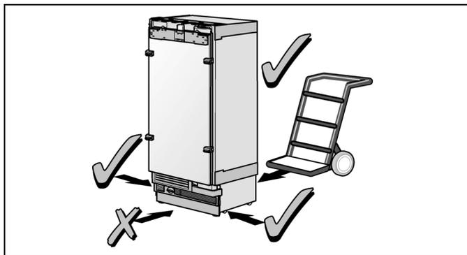
1. Transportez l'appareil avec un moyen adapté au site et à l'appareil lui-même (diable, chariot élévateur / transpalette, chariot).
