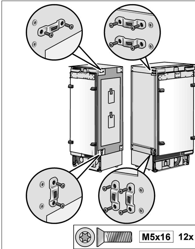
7. Prenez les cornières de liaison dans les accessoires d'installation côte-à-côte et fixez-les chacune sur le côté poignée des deux appareils.
