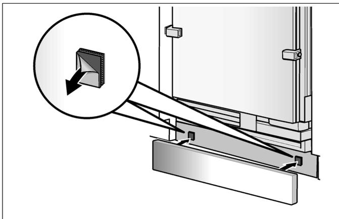
5. Il est possible de visser le bandeau de socle par l'arrière avec l'habillage du socle. L'habillage du socle comporte des trous à cette fin.
