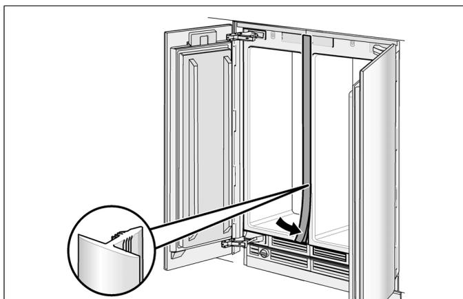
Insérez le profilé de recouvrement dans l'interstice entre les appareils.
