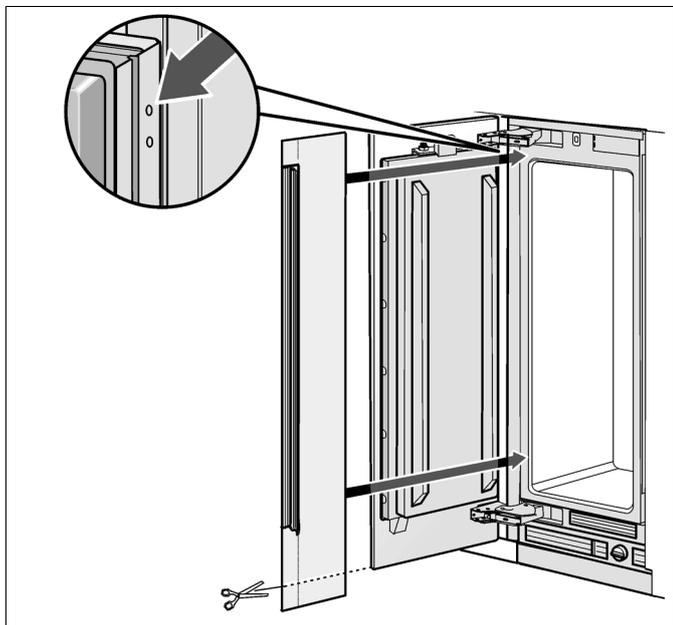
2. Insérez le bandeau protège-doigts dans l'interstice entre l'appareil et la paroi de la cavité (1.).
