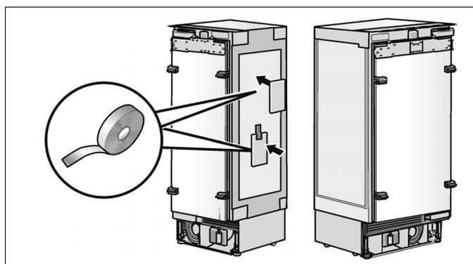
6. Prenez les brides de liaison dans les accessoires d'installation côte-à-côte et fixez-les sur le côté des deux appareils. Pensez à la position des brides !
