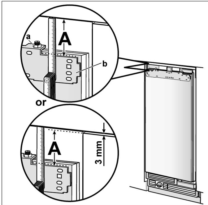
2. Desserrez les 2 écrous (a) et retirez le profilé d'ajustage (b).
