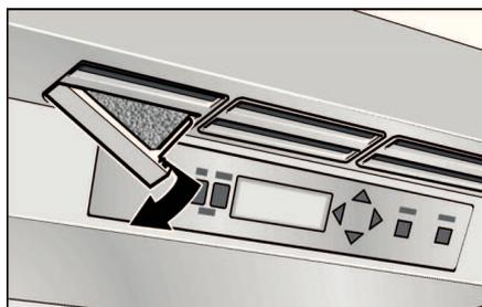
2. Extrayez le filtre à odeurs épuisé et mettez un filtre à odeurs neuf en place.
