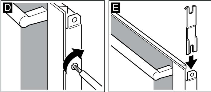
7. Poser le recouvrement et le visser. Si le recouvrement ne peut pas être vissé, vérifier si les vitres reposent correctement dans la fixation.
