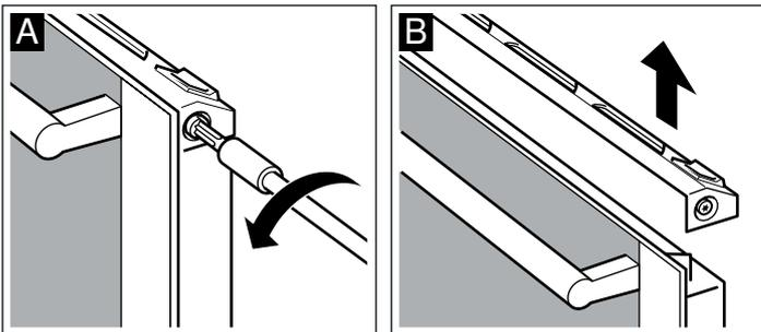
Achten Sie bitte darauf, dass der Backwagen nicht geschlossen wird, solange die Abdeckung abgenommen ist. Die Außenscheibe kann beschädigt werden.
