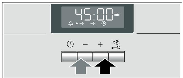
Nach wenigen Sekunden startet der Backofen. In der Anzeige läuft die Dauer sichtbar ab und das Symbol
