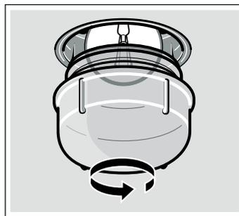
3. Lampe durch den gleichen Lampentyp ersetzen.
