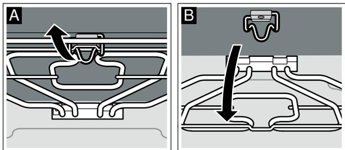
Nach dem Reinigen den Grillheizkörper wieder nach oben klappen. Haltebügel nach unten drücken und den Grillheizkörper einrasten lassen.
