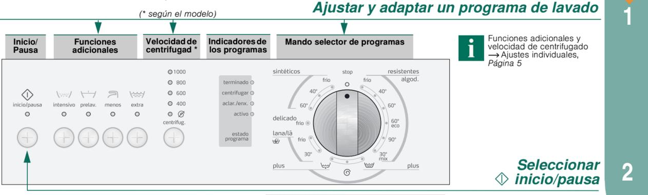
**Mando selector de programas para conectar y desconectar la máquina, así como para seleccionar el programa de lavado que se desea ejecutar. El mando se puede girar en ambas direcciones.**
