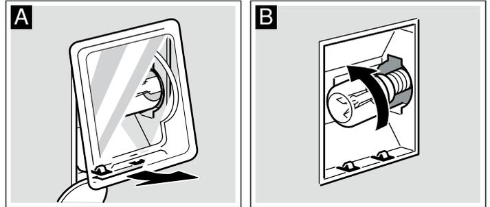
3. Dévisser l'ampoule et la remplacer par un modèle identique (fig. B). En vissant l'ampoule, veiller à ce qu'elle soit droit.
