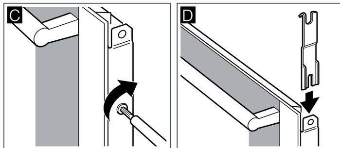
6. Poser le recouvrement et le visser. Si le recouvrement ne peut pas être vissé, vérifier si les vitres reposent correctement dans la fixation.
