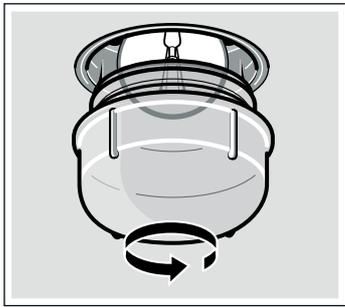
3. Remplacer l'ampoule par un modèle identique.
