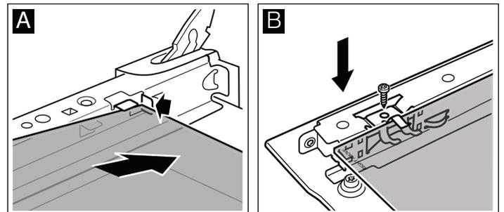
3. Engager la vitre du dessus vers l'arrière en l'inclinant. La face lisse doit être à l'extérieur.
