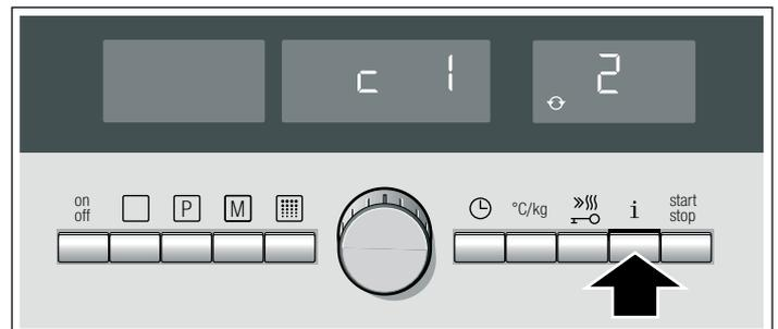
2. Appuyer successivement sur la touche **i** jusqu'à ce que le réglage de base désirée apparaisse.
