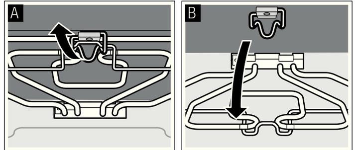
3. Nach dem Reinigen den Grillheizkörper wieder nach oben klappen und halten.
