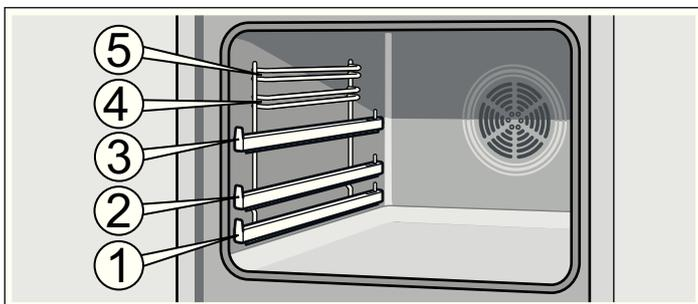
Sie können das Zubehör etwa zur Hälfte herausziehen, ohne dass es kippt. So lassen sich die Gerichte leicht entnehmen. Mit den Auszugsschienen in Höhe 1, 2 und 3 können Sie das Zubehör weiter herausziehen.
