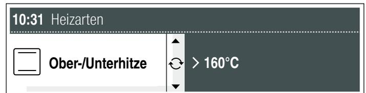
2. Mit Taste zur Temperatur wechseln und mit dem Drehwähler die Temperatur einstellen.
