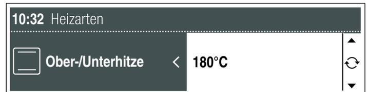
3. Taste drücken. Der Betrieb startet. In der Statuszeile erscheinen die Aufheißbalken der Temperaturkontrolle.
