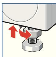
3. Kontermutter gegen das Gehäuse festziehen.
