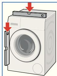
2. Ausrichtung der Waschmaschine mit Wasserwaage überprüfen, evtl. korrigieren. Höhe durch Drehen des Gerätetefußes verändern.
