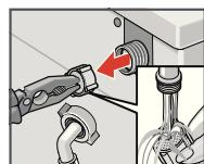
Sieb mit Zange herausnehmen und reinigen.
