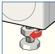
1. Kontermutter mit Schraubenschlüssel im Uhrzeigersinn lösen.
