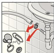
2. Schlauchschelle lösen, Ablaufschlauch vorsichtig abziehen.
