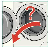
2. Prüfen, ob die Trommel vollständig entleert ist. Ggf. entleeren. Nur so ist eine fehlerfreie Funktion der Beladungsanzeige gewährleistet. → Seite 34
