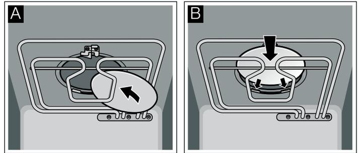
3. Empujar las grapas hacia adelante y presionar el vidrio protector hacia arriba. Soltar las grapas. (Figura C)
