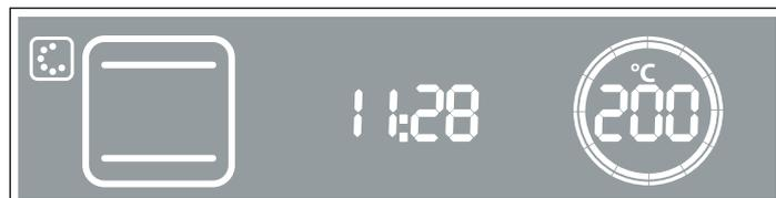
En los niveles de grill y el programa automático aparecen directamente todas las barras. En la función de microondas no se visualizan las fases de calentamiento.
