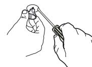
3. Reemplazarlo con uno nuevo de características iguales, (foco halógeno comercial, 12 Voltios, máx. 20 vatios, enganche GU4).
