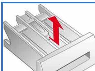
Waschmittelschublade offen lassen, damit Restwasser abtrocknen kann.
