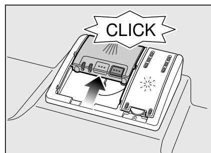
Le compartiment à détergent s'ouvre automatiquement au moment optimal, en fonction du programme. Le détergent en poudre ou liquide se répartit dans l'appareil et se dissout. La pastille tombe dans l'appareil et s'y dissout.
