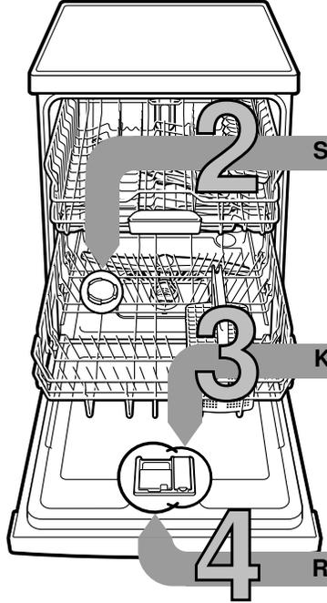
**Spezialsalz einfüllen** Löst Kalk (nicht nötig bei Einstellwert 0!) ...
