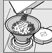
Spezialsalz einfüllen (nie Reiniger einfüllen!).
