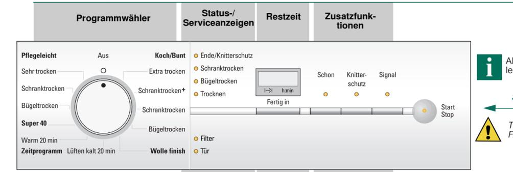
Blinkt → Flusensieb reinigen, Abluftleitung prüfen → Seite 6.
