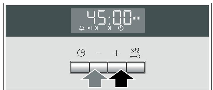
Nach wenigen Sekunden startet der Backofen. In der Anzeige läuft die Dauer sichtbar ab und das Symbol
