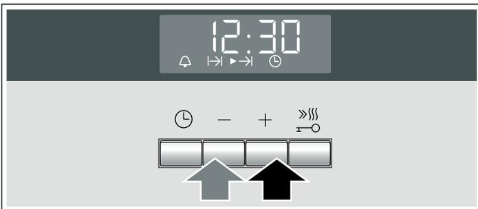
Nach wenigen Sekunden übernimmt der Backofen die Einstellungen und schaltet in Warteposition. In der Anzeige steht die Uhrzeit, zu der das Gericht fertig ist, und vor dem Symbol **→I** steht der Pfeil **▶**. Symbol **⌚** und **⌚** erlöschen. Wenn der Backofen startet, läuft die Dauer sichtbar ab und der Pfeil **▶** steht vor dem Symbol **I→I**. Das Symbol **→I** erlischt.
