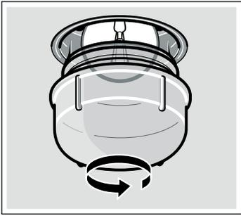
3. Lampe durch den gleichen Lampentyp ersetzen.
